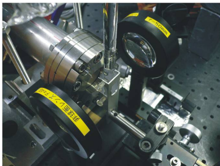
図 10 電子ビーム・分析光のサンプルへの照射 第 88 号 (2009)
