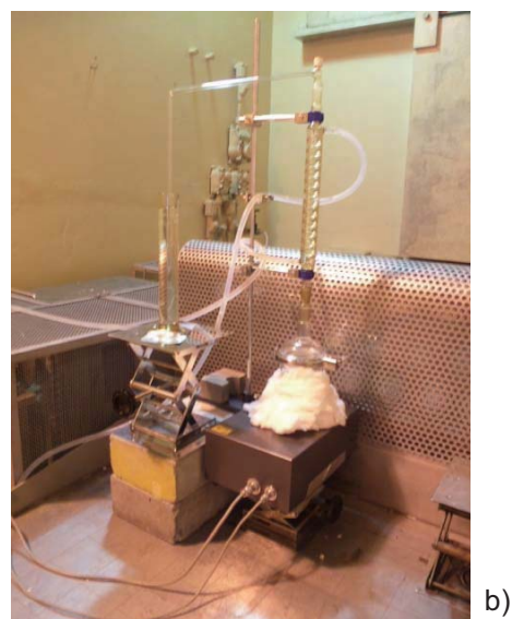
図 1 非沸騰、沸騰下での水試料の照射の概要 a) とその写真 b)
