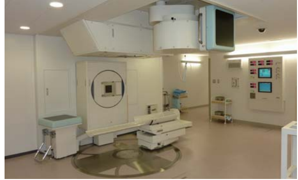
写真4 治療室（水平・垂直ポート）。6軸動作が可能な治療寝台，患者位置決めの際に直交2方向のX線撮影に用いられる FPD (Flat Panel Ditector, 写真では退避状態)が見られる。
