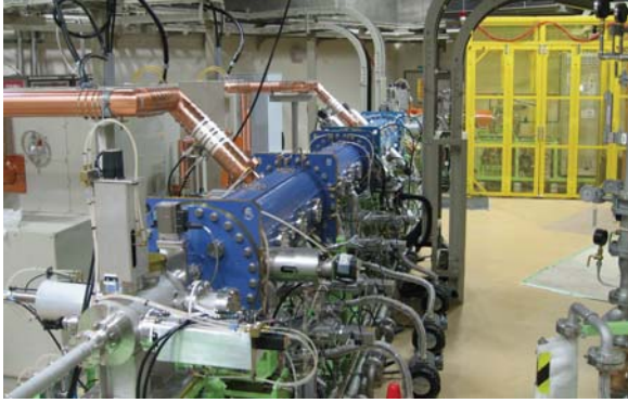
写真2 入射器の外観。奥側にイオン源，手前側に RFQ 及び IH-DTL が配置されている。
