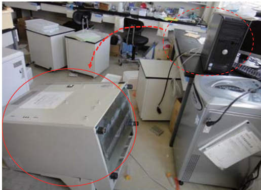
写真: 実験台上の DNA シーケンサが落下し大破した。
