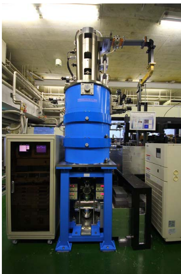
図 1 フェムト秒時間分解・MeV 電子顕微鏡実証機の写真。
