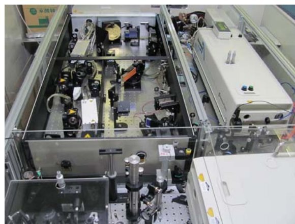
図 7 フェムト秒 Ti:Sapphire レーザーの構成.
